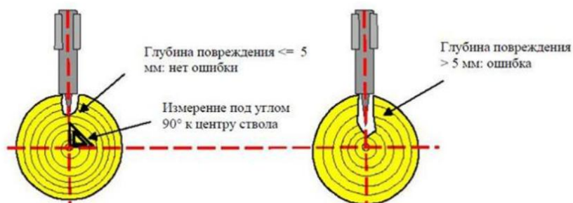
Рисунок 1.14. – Измерение слишком глубоких повреждений под углом 90^\circ к центру ствола
