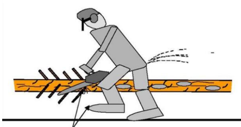
Рисунок 1.17 – Неправильное перемещение при обрезке сучьев
